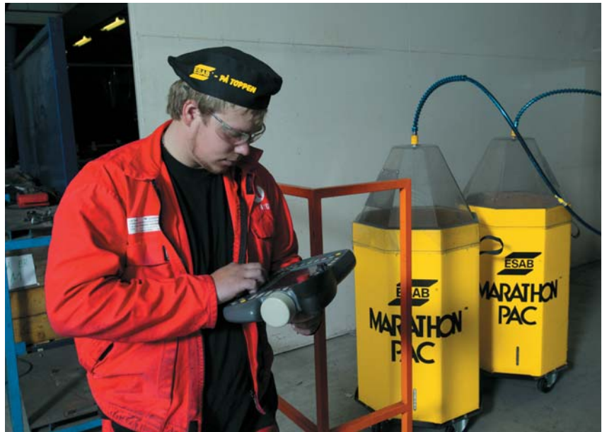
Фигура 3. Операторът програмира заваръчен робот извън клетката за заваряване.
